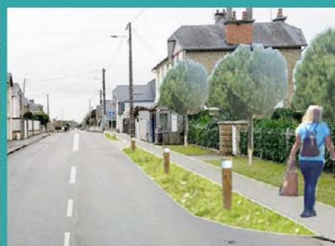
Le cheminement piétons est positionné du côté de l'établissement « Hôtel des Falaises ». Un rideau de ganivelles complètera les potelets en bois. La réalisation de l'aménagement côté Est permettra aussi de sécuriser les abords de l'arrêt de bus « Edenville »
