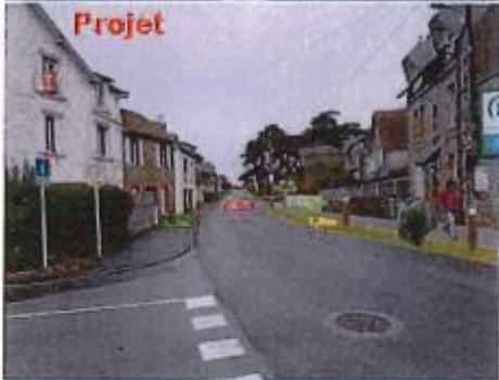
Après la courbe, la largeur de la chaussée passe de 5,90m à 5,70m, ce qui permet une réduction de la vitesse.
